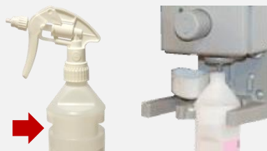
Fyllið SURE flöskuna með vatni upp að skörðunum og festið hana undir skammtarann Fill the SURE bottle with water up to the grooves and fasten it under the dispenser
